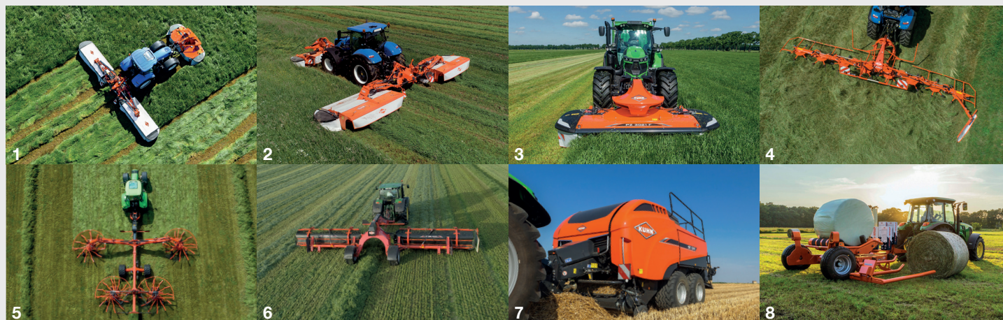
1. Дисковые косилки – 2. Дисковые косилки-плющилки – 3. Барабанные косилки – 4. Ротационные ворошители 5. Валкообразователи – 6. Валкообразователи с ленточным транспортером – 7. Пресс-подборщики – 8. Обмотчики
